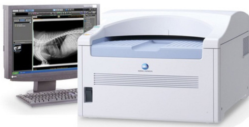
Czytnik CR-Regius SIGMA z konsolą IMAGEPILOT: element cyfrowego systemu RTG dla weterynarii.
